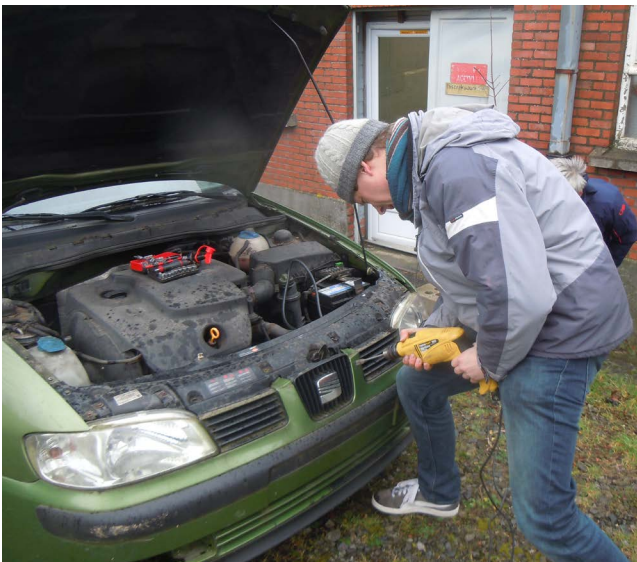
Jan installeert de hoofdschakelaar op de Seat
